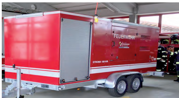
Das neue Notstromaggregat mit einer Leistung von 100 kVA
