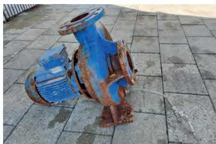
Ein Energiefresser weniger: eine der ausrangierten Badewasserumwälzpumpen
